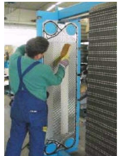
Рис. 10. Очистка поверхности пластины с помощью мягкой щетки.
