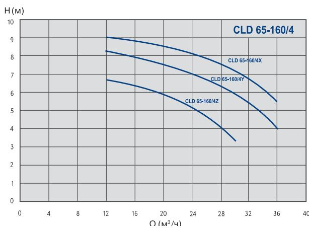
**Сдвоенные центробежные насосы с сухим ротором
