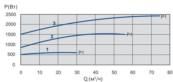
**Сдвоенный фланцевый трёхскоростной циркуляционный насос
