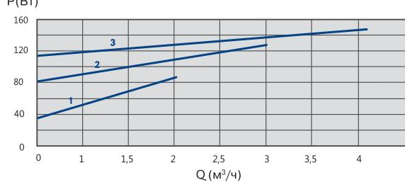
**Фланцевые циркуляционные насосы для систем горячего водоснабжения
