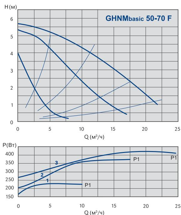
**Сдвоенный фланцевый трёхскоростной циркуляционный насос
