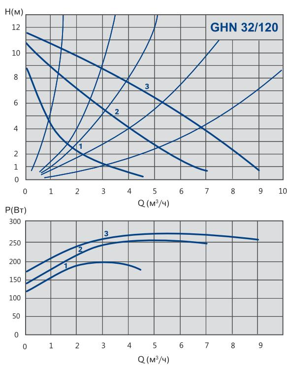
**Резьбовой трёхскоростной циркуляционный насос – два мотора**
