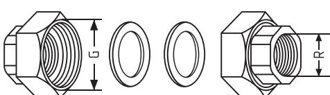
Резьбовые соединения для циркуляционных насосов IMP PUMPS
