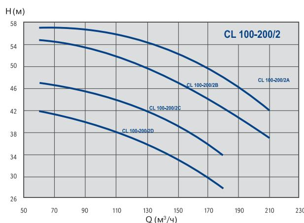
**Сдвоенные центробежные насосы с сухим ротором
