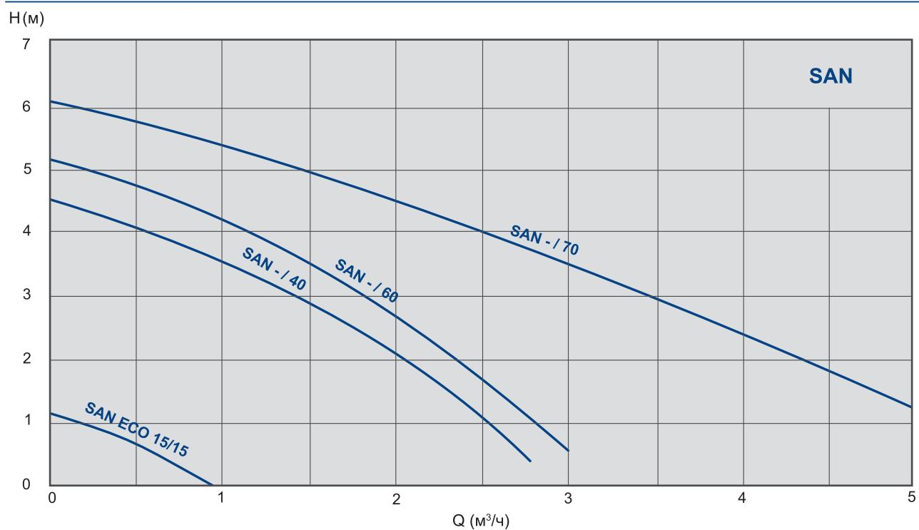
**Резьбовые циркуляционные насосы для систем горячего водоснабжения
