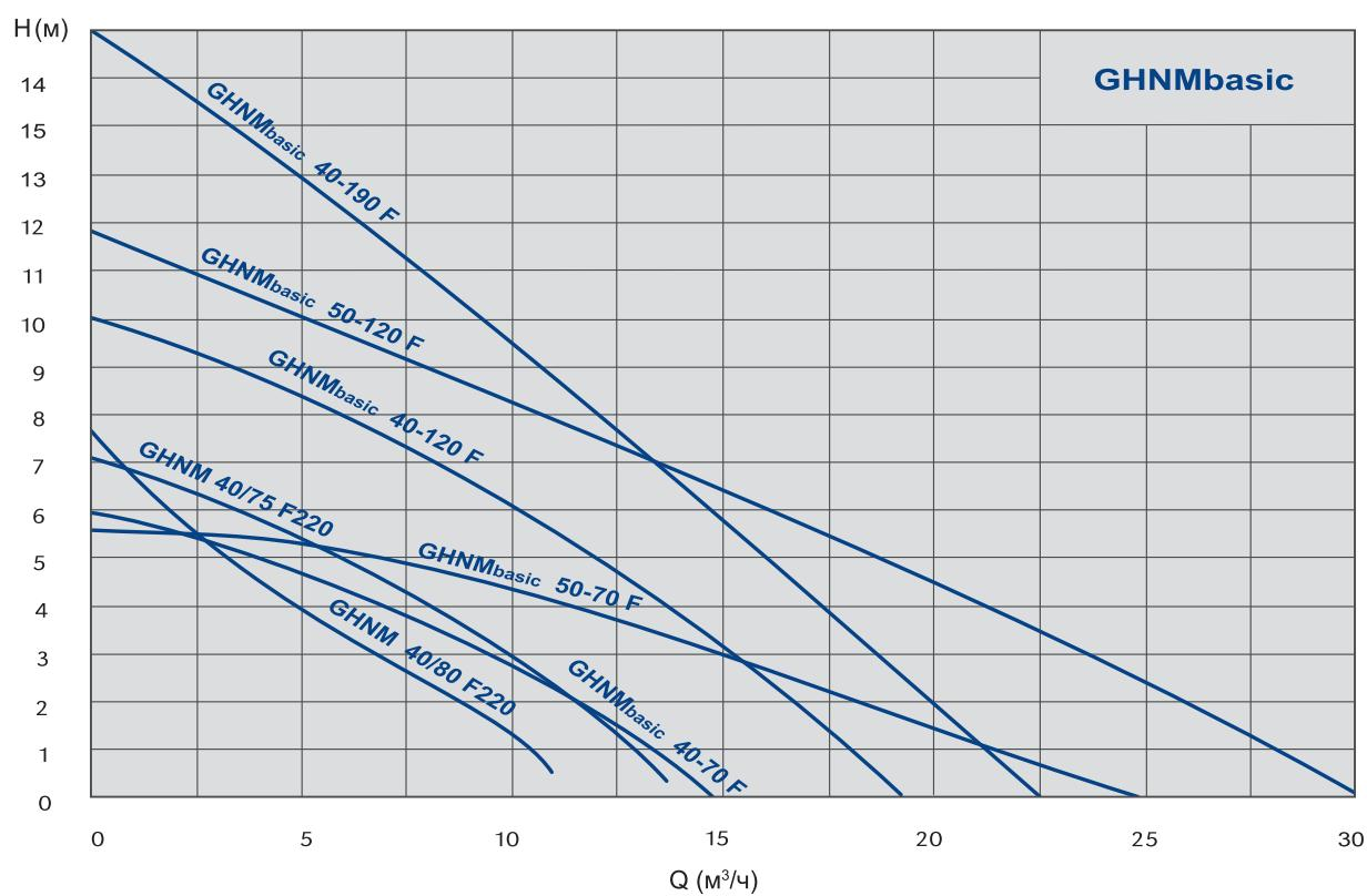
**Фланцевый трёхскоростной циркуляционный насос
